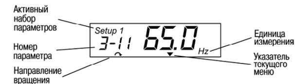
Рис. 5.5. Отображение информации на ЖКИ
