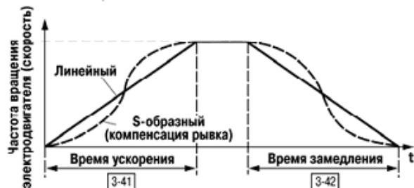
Рис. 5.6. Характеристики разгона/торможения
