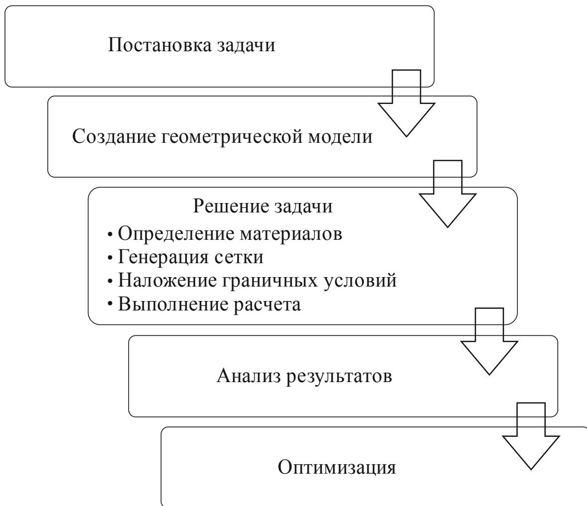
Рисунок 2.1 – Общая схема методики компьютерного инженерного анализа
