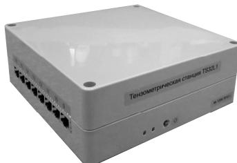
Рис. 8.2. Внешний вид электронного блока станции
