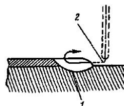
*Рис. 10.13. Схема повторного зажигания дуги:
