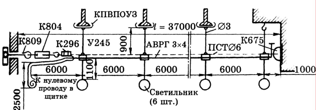
Рис. 6.2. Эскиз тросовой электропроводки
