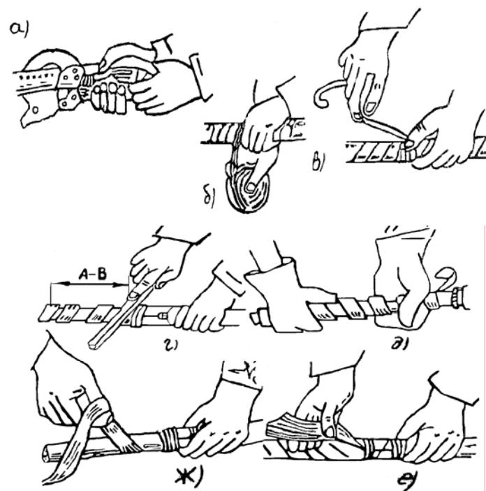
*Рис. 3.7. Операции по резке концов кабелей, наложению бандажей и удалению покровов:*
