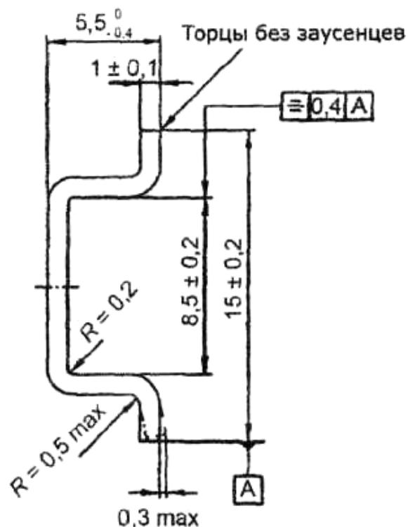
Рис. 12.4. Т-образная направляющая шириной 15 мм для крепления аппаратуры
