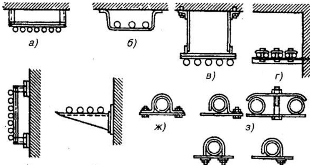
*Рис. 7.1. Способы крепления труб к опорным конструкциям:*
