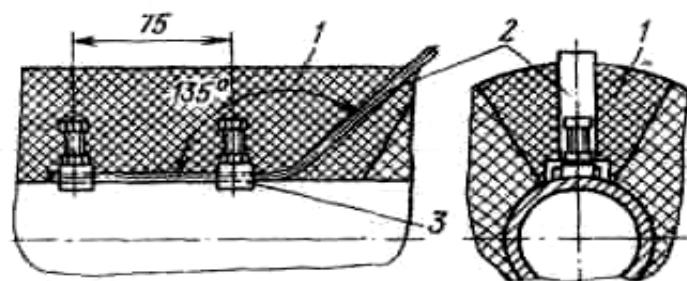
Рис. 13.7. Установка термоэлектрического поверхностного термометра на трубопроводе
