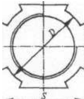
*Рис. 7.18. Гайки установочные заземляющие: D – диаметр гайки*
