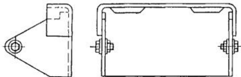
Рис. 9.4. Заглушки торцовые для закрывания металлических коробов
