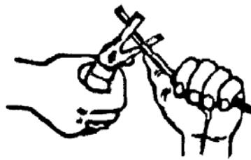
Рис. 3.18. Снятие изоляции
