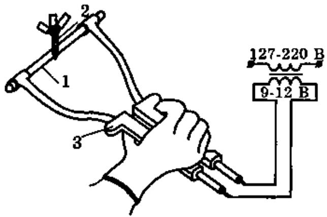
*Рис. 4.7. Соединение алюминиевых жил в клещах с двумя угольными электродами:
