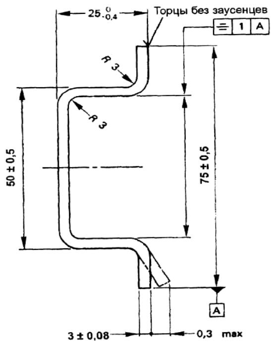
Рис. 12.6. Т-образная направляющая шириной 75 мм для крепления аппаратуры
