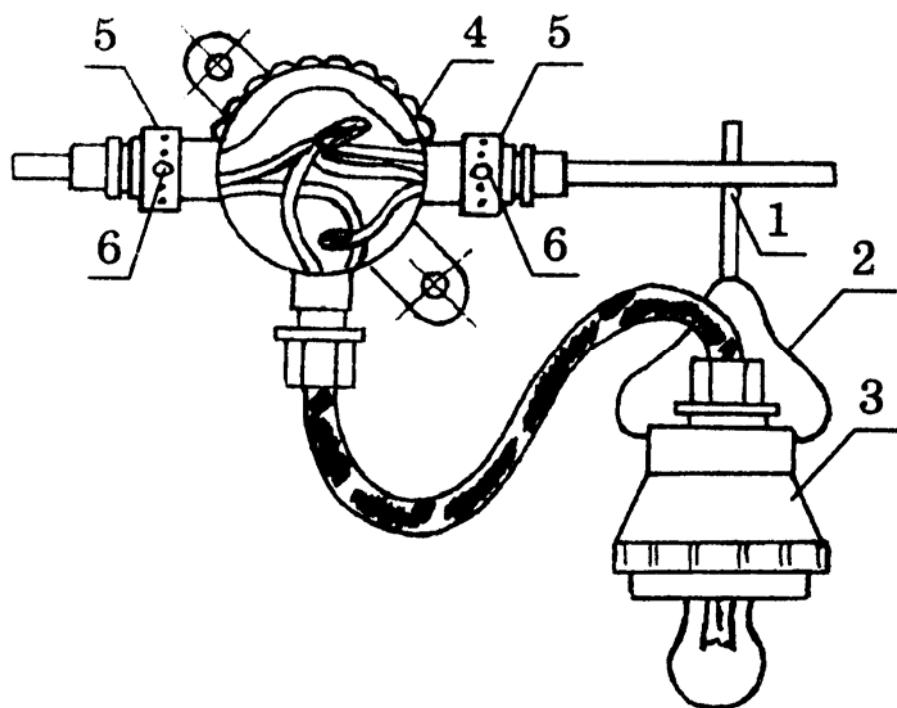
*Рис. 6.6. Раздельное крепление ответвительной коробки и светильника к несущему тросу:*
