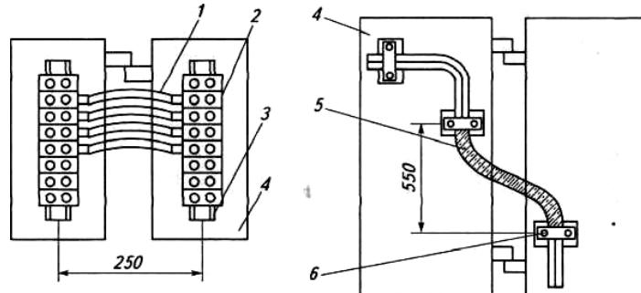
*Рис. 13.8. Гибкие соединения:*
