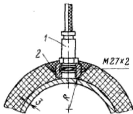
Рис. 13.5. Установка термометра сопротивления поверхностного по ТМ4-167-75:
