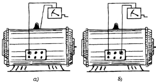
*Рис. 5.6. Измерение сопротивления изоляции обмоток трехфазного асинхронного электродвигателя:*
