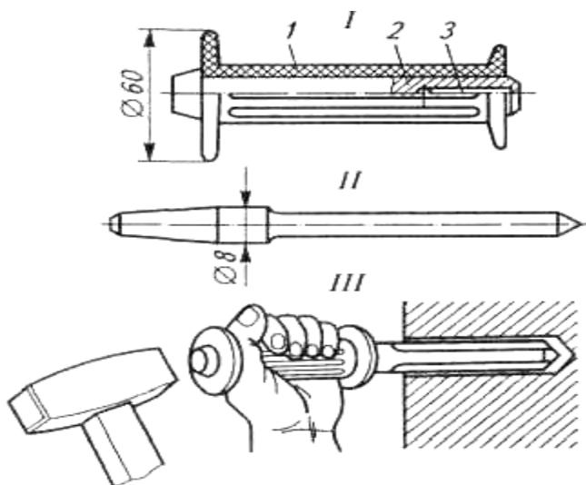
Рис. 8.3. Пробивка гнезд ручным пробойником и оправкой:
