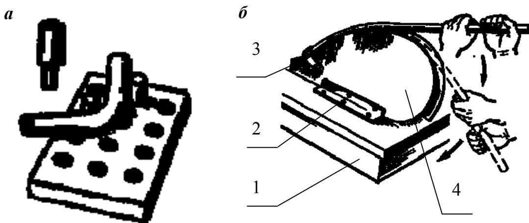
Рис. 7.9. Гибка трубы в холодном состоянии:
