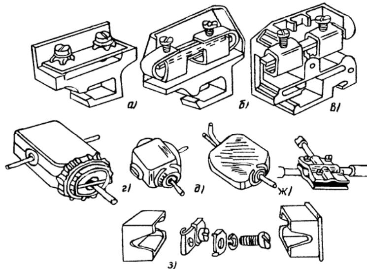
*Рис. 4.2. Механические зажимы:
