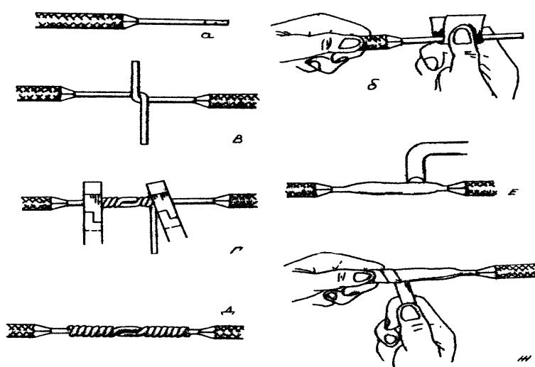
Рис. 4.9. Соединение медных жил пропаянной скруткой
