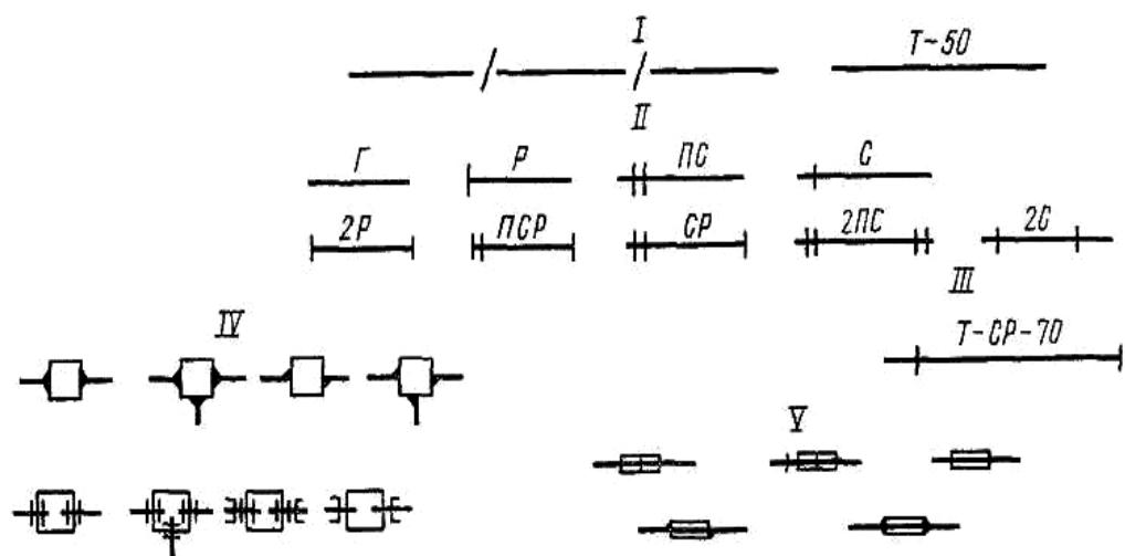
Рис. 7.6. Условные обозначения трубных разводок
