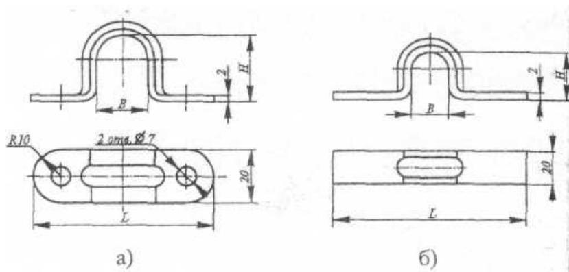
Рис. 8.4. Скобы: а – типа К142–К145, б – типа К729–К740
