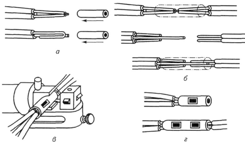
Рис. 3.21. Опрессовка алюминиевых проводов в гильзах ГАО:
