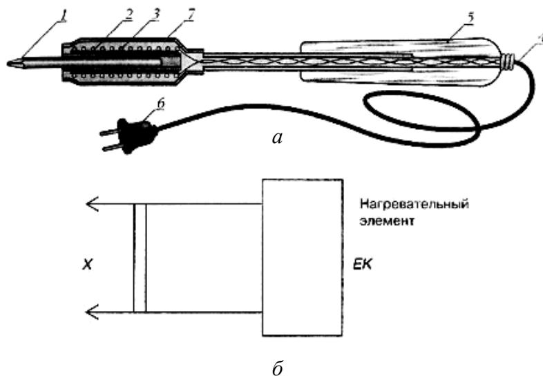
*Рис. 3.14. Электрический паяльник:*
