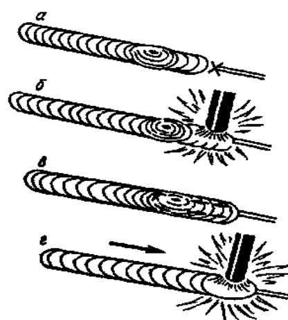
*Рис. 10.14. Возобновление сварки:
