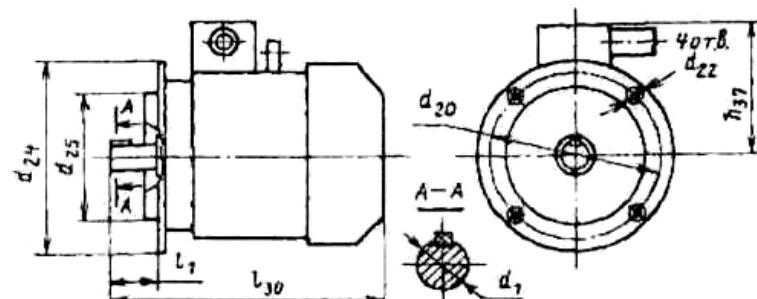
Рис. 5.4, б. Габаритные, установочные и присоединительные размеры двигателей серии АИР фланцевого исполнения
