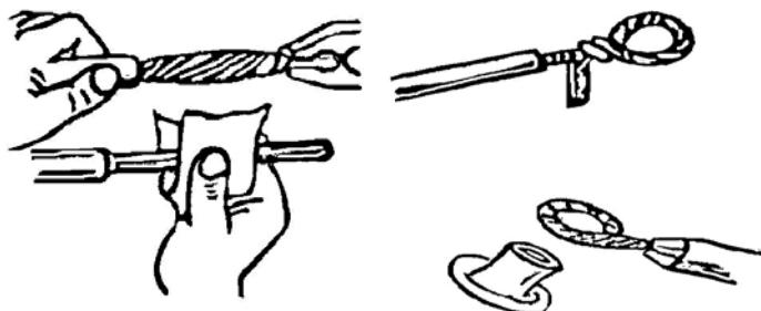
Рис. 3.19. Подготовка жилы и наконечника для опрессовки
