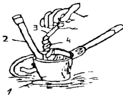
Рис. 3.6. Проверка бумажной изоляции кабеля на влажность:
