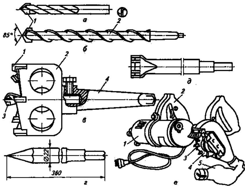
Рис. 8.6. Инструмент для пробивки отверстий, ниш и борозд:
