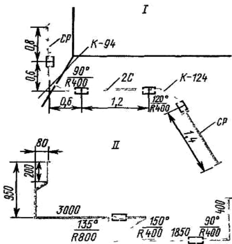
Рис. 7.7. Эскизы заготовки трубных электропроводок из нормализованных элементов
