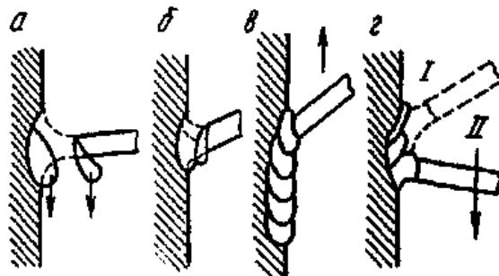
*Рис. 10.21.* Сварка вертикальных швов
