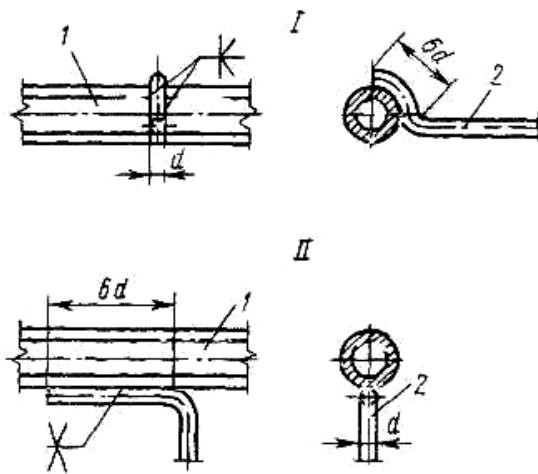
Рис. 7.21. Соединение заземляющих проводников с трубами
