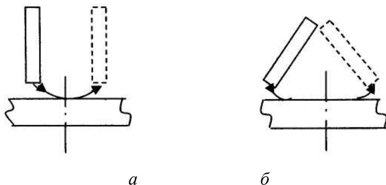
Рис. 10.12. Схема возбуждения дуги:
