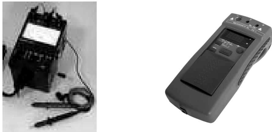
Рис. 2.14. Мегаомметры
