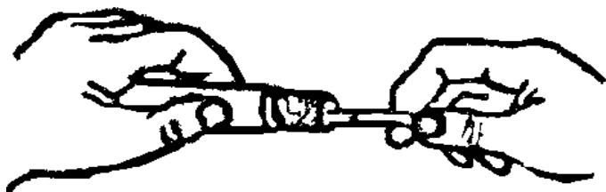
Рис. 3.23. Смазка внутренней поверхности гильзы
