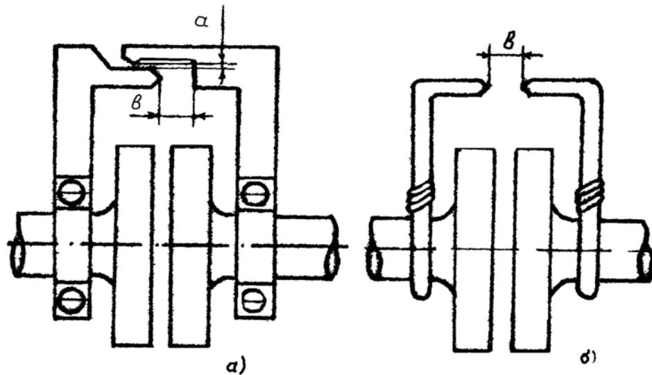
Рис. 5.8. Выверка установки электродвигателя и рабочей машины, соединенных муфтой:
