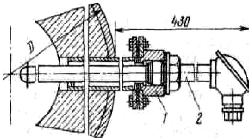
Рис. 13.3. Установка термоэлектрического термометра в оправе фланцевой с бобышкой на трубопроводе ( $D = 530$  мм) или металлической стенке с внутренней кирпичной кладкой по ТМ4-153-75: 1 – закладная конструкция по ЗК4-17-75; 2 – термометр
