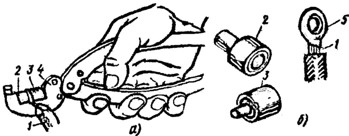
Рис. 3.17. Обжатие кольцевого наконечника (а); готовое соединение (б):
