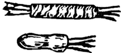
Рис. 3.27. Изолировка места опрессовки
