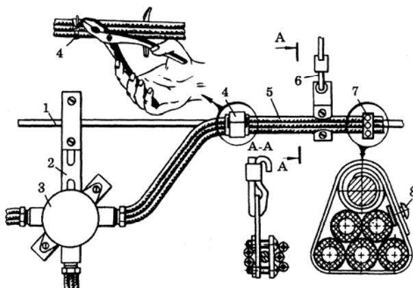
*Рис. 6.3. Технология крепления проводов и коробок к тросу:*
