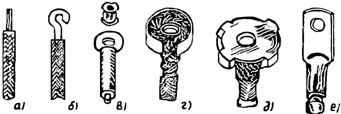
Рис. 3.15. Виды оконцевания жил проводов и кабелей:
