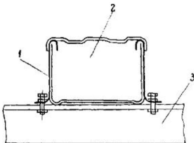
Рис. 9.6. Крепление коробов к конструкциям:
