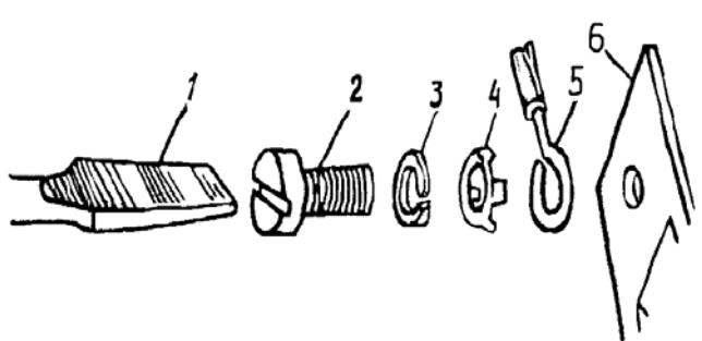
*Рис. 4.8. Присоединение жилы к плоскому выводу электрического аппарата:*
