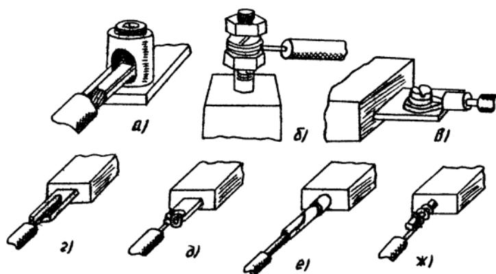
Рис. 4.1. Контактные вводы электрооборудования:
