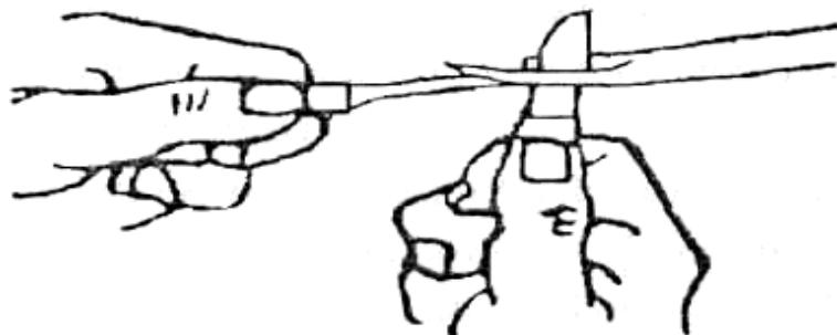
Рис. 3.5. Снятие изоляции монтерским ножом
