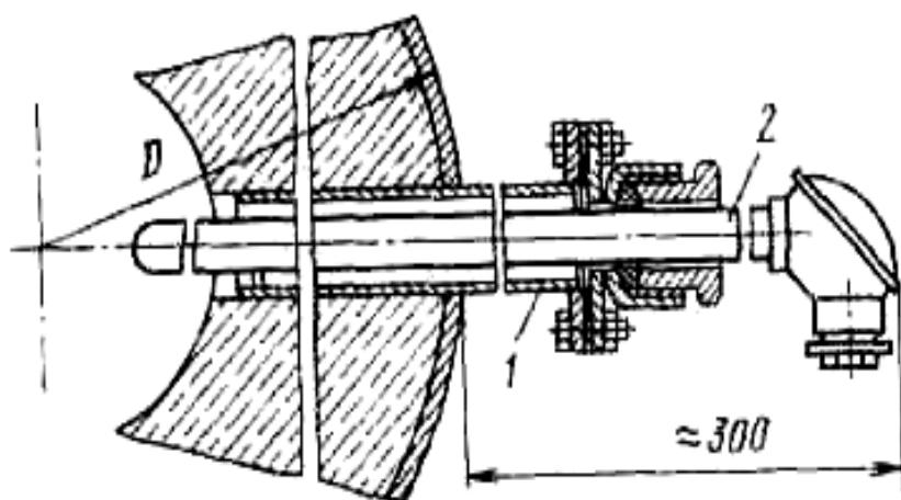
Рис. 13.4. Установка термоэлектрического термометра в оправе фланцевой с сальником на трубопроводе ( $D = 530$  мм) или металлической стенке с внутренней кирпичной кладкой по ТМ4-155-75: 1 – закладная конструкция по ЗК4-19-75; 2 – термометр
