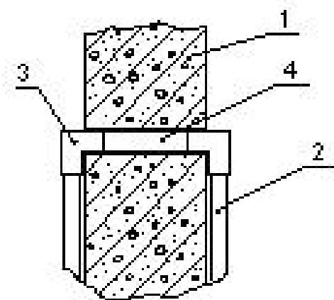
Рис. 9.8. Проход кабеля сквозь стену
