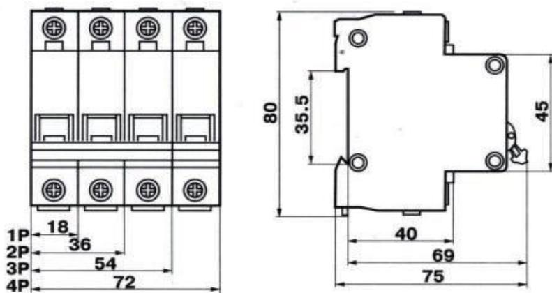
Рис. 12.1. Габаритные и установочные размеры ВН-32 (4 полюса)
