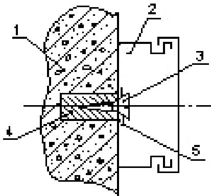
Рис. 9.7. Крепление коробов к несущей конструкции:
