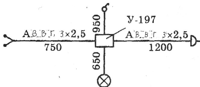
*Рис. 8.7. Эскиз замеров электропроводки*
