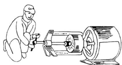
*Рис. 5.3. Снятие шкива с вала электрического двигателя двуххлапчатой скобой*
