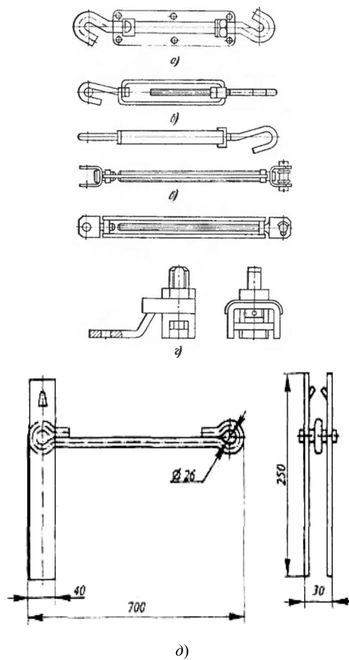
*Рис. 6.1. Муфты и приспособления для натяжения тросов и струн:*
