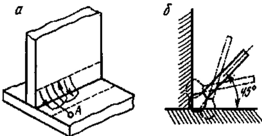
Рис. 10.20. Схема колебательных движений электродом при однослойной сварке угловых швов: *а* – траектория движения конца электрода; *б* – изменение угла наклона электрода; *A* – точка начала сварки
