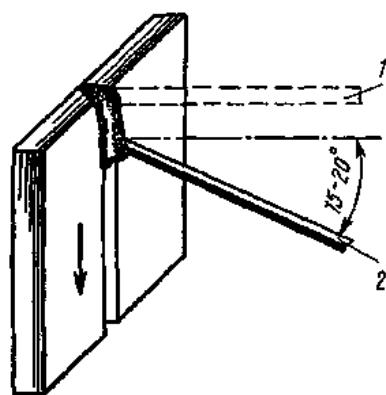
*Рис. 10.22.* Положение электрода при возбуждении дуги (1) и при сварке (2)
