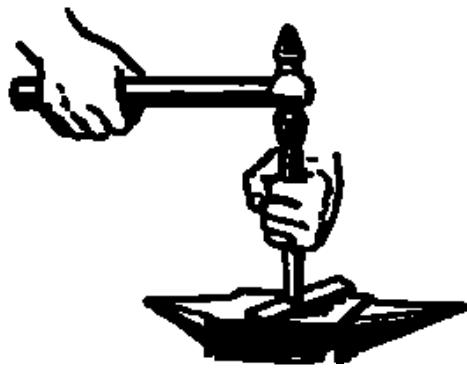
Рис. 10.8. Рубка полосового металла
