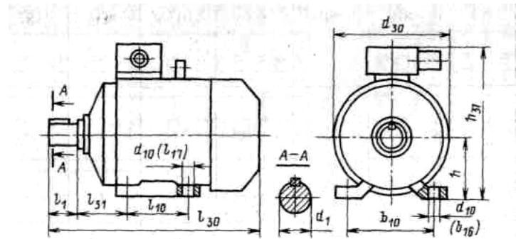
Рис. 5.4, а. Габаритные, установочные и присоединительные размеры двигателей серии АИР исполнения на лапах
