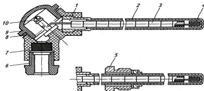
*Рис. 13.1. Конструкция термоэлектрического преобразователя на основе термопары:*
