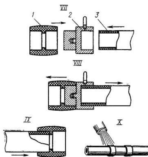
*Rис. 7.20. Соединение пластмассовых труб между собой и уголками*
