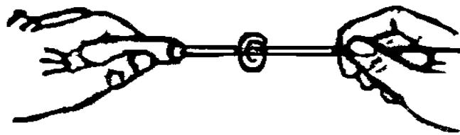
Рис. 3.22. Зачистка внутренней поверхности гильзы
