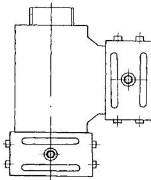
Рис. 9.2. Тройник для металлических коробов
