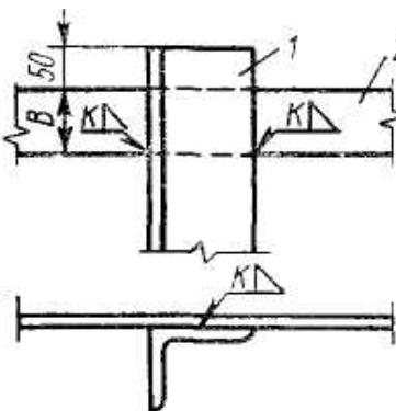
*Рис. 10.4. Соединение электрода-заземлителя из угловой стали с заземляющим проводником из полосовой стали*
