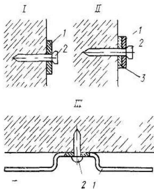
*Рис. 10.18. Крепление заземляющих проводников непосредственно к основанию*
