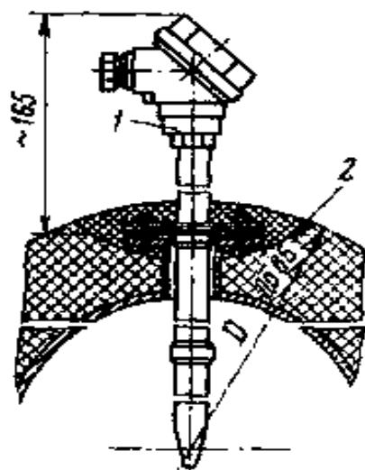
Рис. 13.6. Установка термоэлектрического термометра с фланцем на трубопроводе
