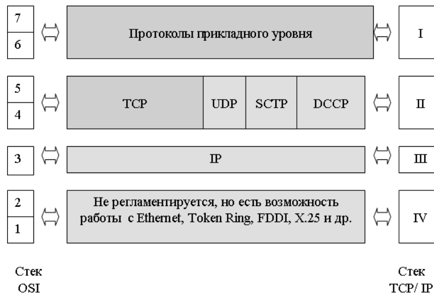
Рис. 3.4. Соответствие стека TCP/IP модели OSI
