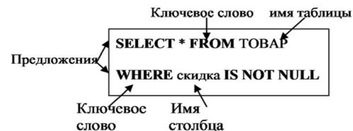
Рис. 4.9. Структура оператора SELECT в языке SQL
