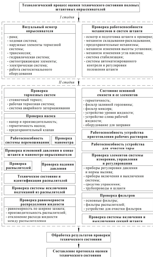
Рисунок 1. – Структурная схема процесса оценки технического состояния полевых штанговых опрыскивателей
