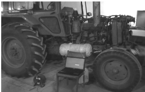
Рисунок 4 – Установка теплового аккумулятора на трактор МТЗ
