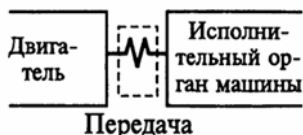
Рисунок 1 – Привод рабочего органа машины
