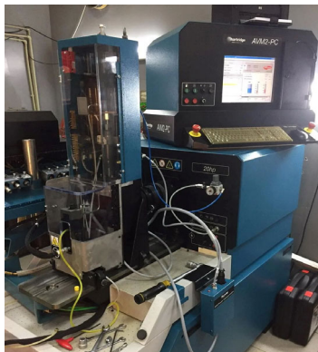
Рисунок 1 – Стенд AVM2-PC с камбоксом и системой управления НК-1500 («Hartridge Ltd», United Kingdom)
