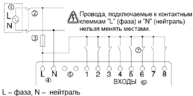
Рисунок П1.2 – Схема электрических соединений с источником питания переменного тока и входными цепями: 1 – источник питания переменного тока (= 24 В); 2 – устройство отсоединения цепи; 3 – устройство защиты схемы (ограничение до 1 А); 4 - контактные клеммы подключения источника питания переменного тока; 5 – неиспользуемые контактные клеммы; 6 – входные контактные клеммы; 7 – цифровые входные выключатели
