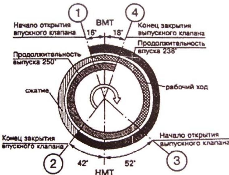
Рис. 4.7. Диаграмма фаз газораспределения двигателя Д-260
