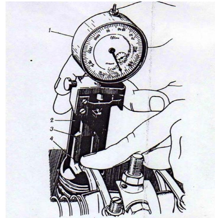
Рис. 4.9. Измерение зазора между штоком клапана и бойком коромысла устройством КИ-9918:
