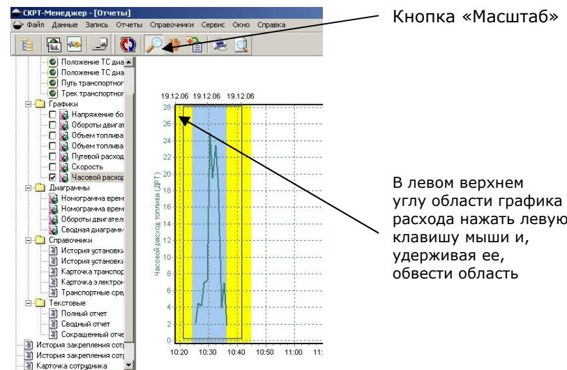
Рис. 2.27. График расхода топлива
