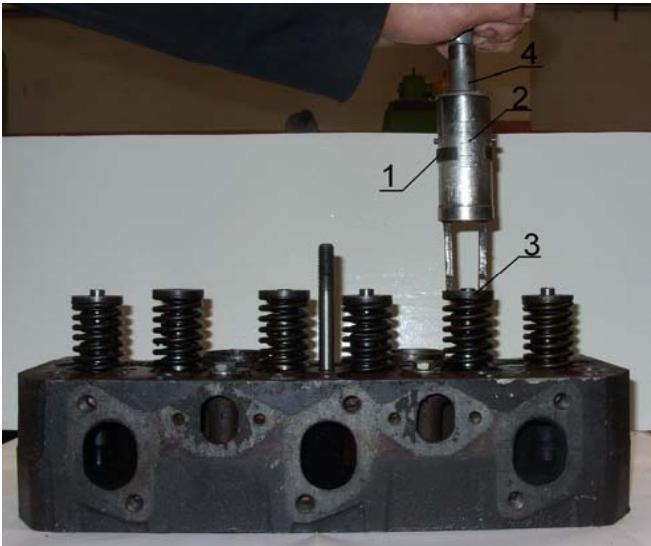
Рис. 4.10. Проверка упругости клапанных пружин прибором КИ-723
