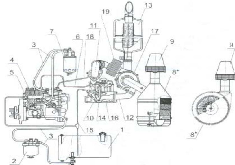
Рис. 1.4. Схема системы питания дизелей Д-245.16С, Д-245.16ЛС:
