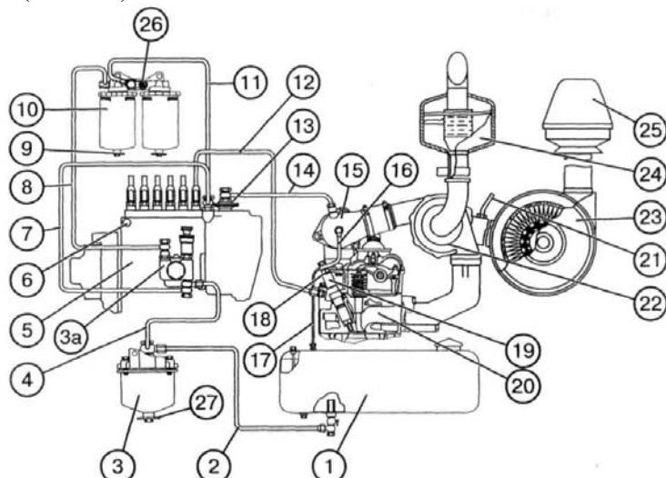
Рис. 1.5. Схема системы питания дизеля:
