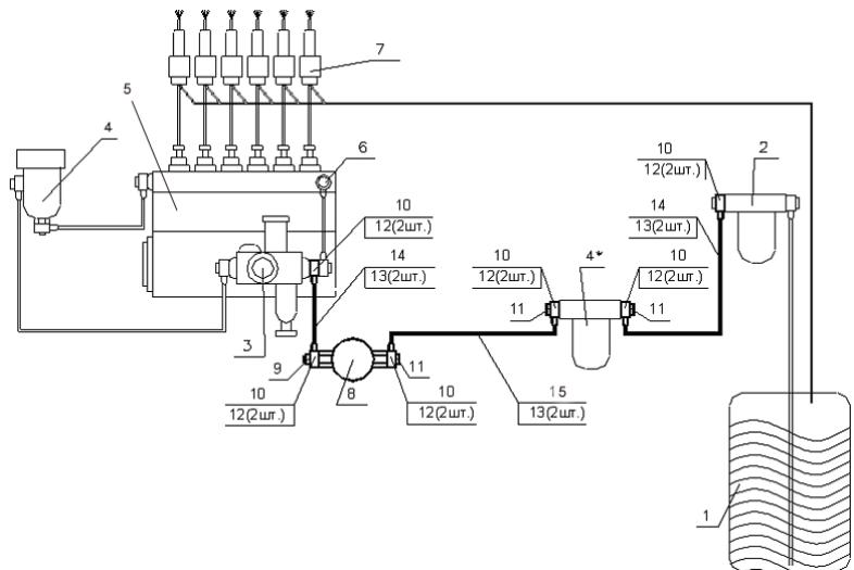
Рис. 2.7. Принципиальная схема включения ДРТ-5 на разрежение без слива обратки
