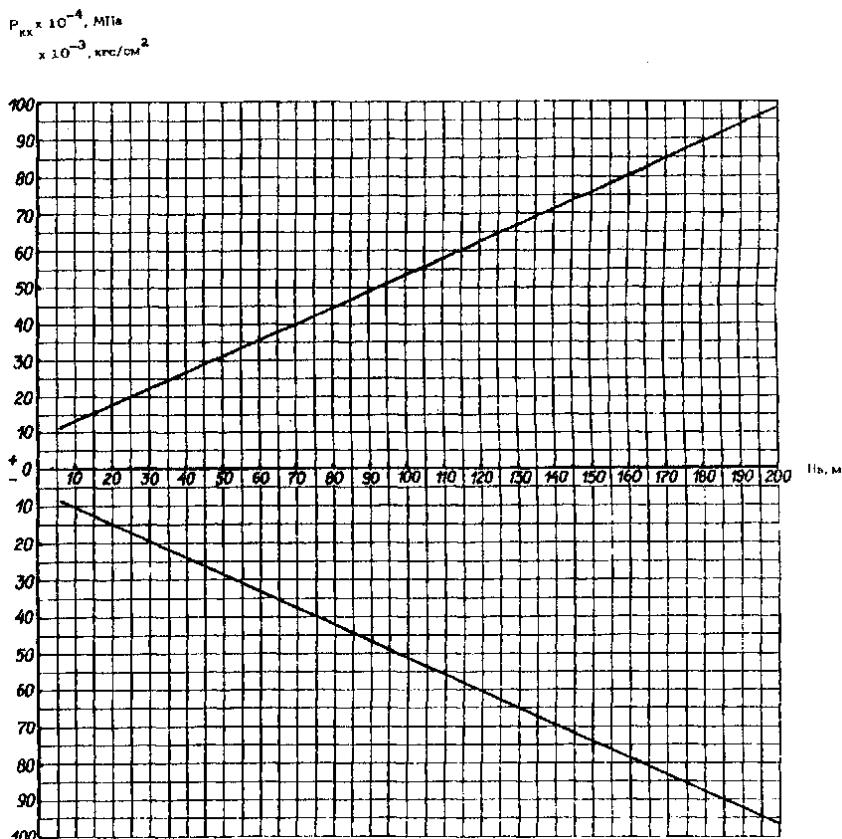
Рис.3.3. Градуировочная характеристика для определения давления наддува  $P_{кx}$  (при открытом дросселе)
