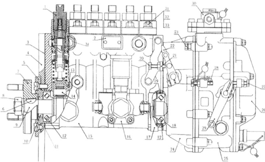
Рис. 1.6. Топливный насос высокого давления:
