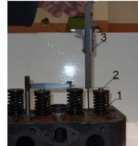
Рис. 4.12. Измерение расстояния между верхней обработанной поверхностью головки цилиндров и торцом стержня клапана: 1 – верхняя обработанная поверхность головки цилиндров; 2 – торец стержня клапана; 3 – штангенглубиномер ШГ-160
