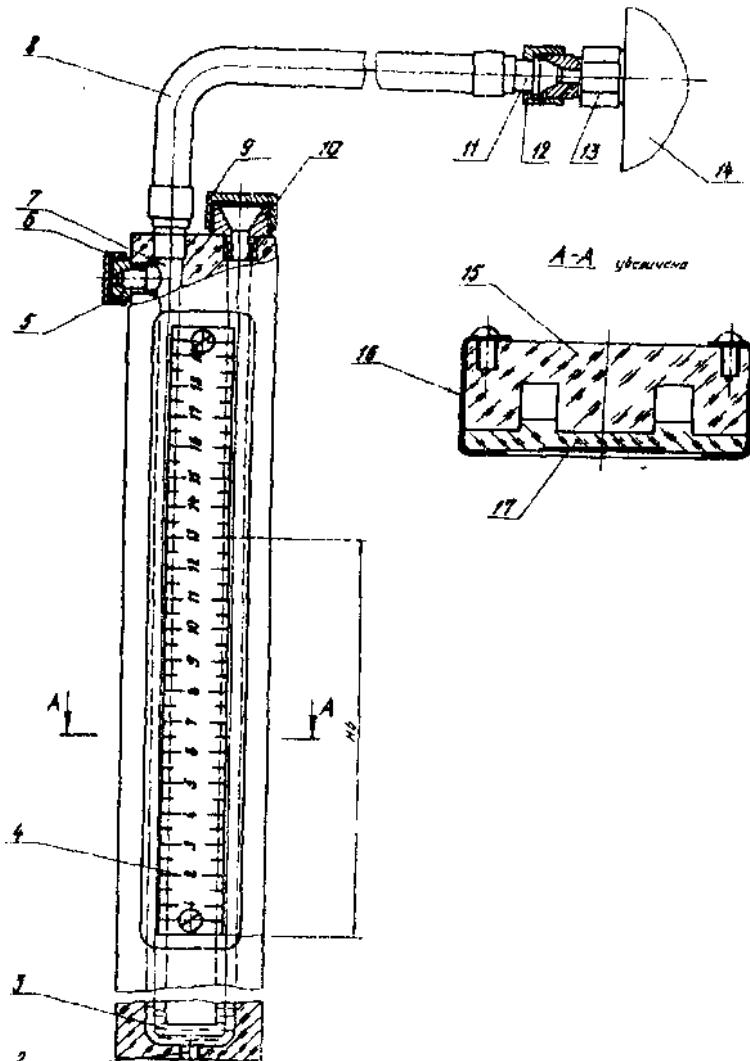
Рис. 3.2. Устройство для определения давления наддува КИ-13932 ГОСНИТИ:
