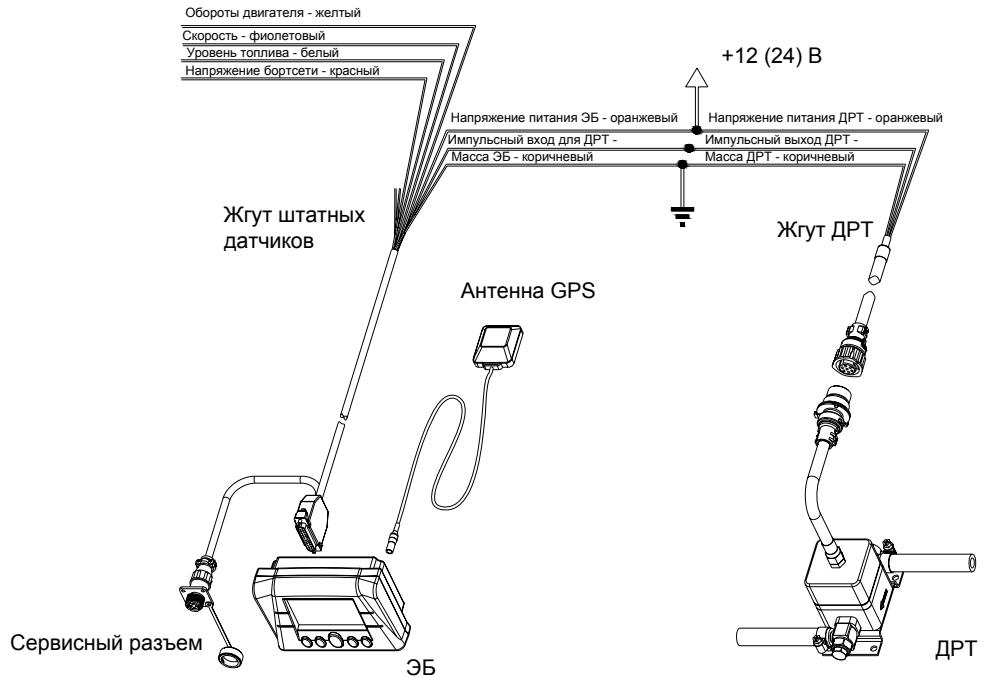
Рис. 2.5. Схема подключения СКПТ с ДРТ
