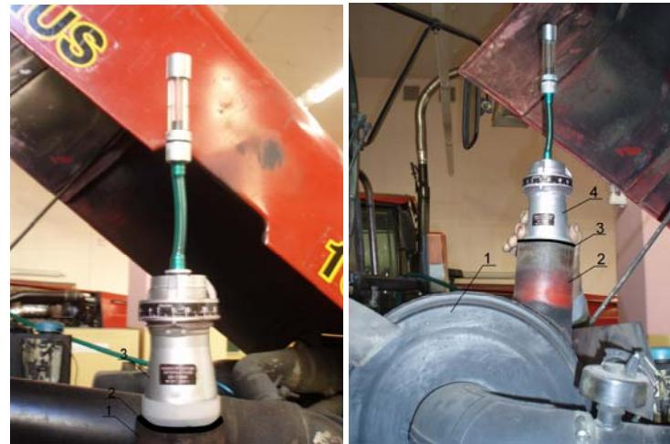
Рис. 4.5. Установка индикатора расхода газов КИМ-13671 на выпускную трубу: 1 – выпускная труба; 2 – проставка; 3 – индикатор расхода газов КИ-13671
