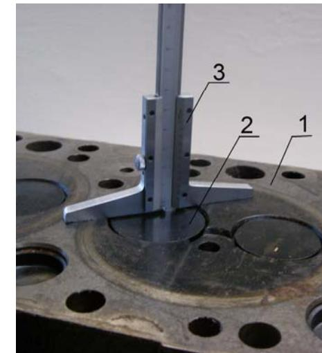
Рис. 4.11. Измерение утопания тарелок клапанов относительно нижней плоскости головки цилиндров штангенглубиномером ШГ-160:
