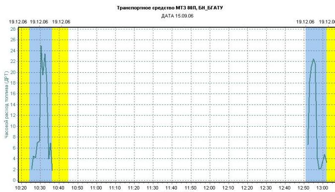
Рис. 2.26. График часового расхода топлива
