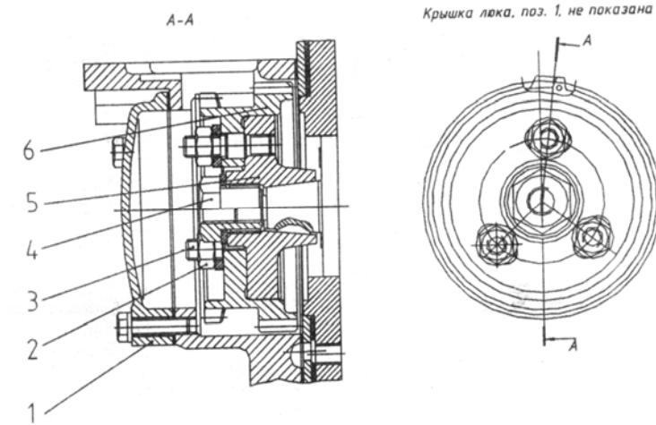
Рис. 1.7. Привод топливного насоса:
