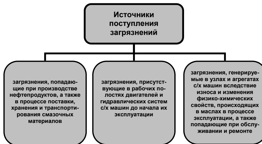
Рисунок 4.1 – Источники поступления загрязнений в смазочные жидкости
