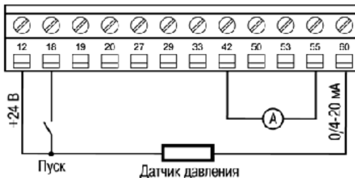
Рис. 10.12. Схема подключений для конфигурации «поддержание заданного давления»
