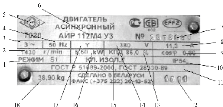
Рис. 3.2. Заводской щиток асинхронного электродвигателя серии АИР:
