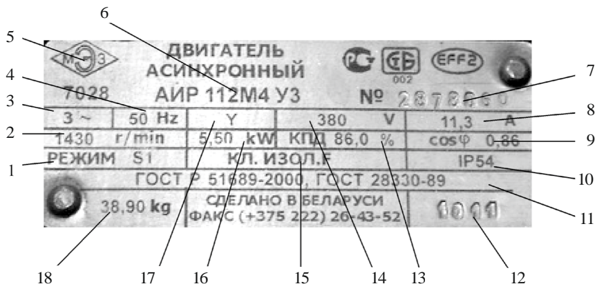
Рис. 3.2. Заводской щиток асинхронного электродвигателя серии АИР:
