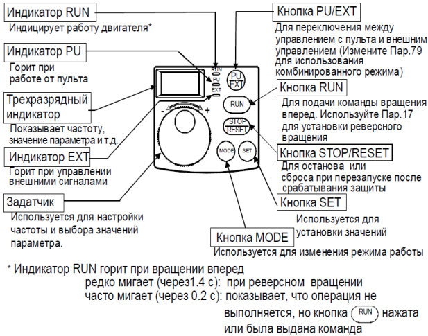
Рис. 14.5. Общий вид пульта управления ПЧ и назначение органов управления
