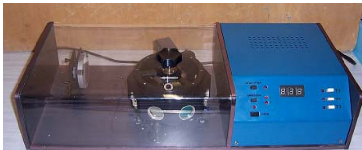
Рис. 2.3. Общий вид лабораторной установки для изучения законов теплового излучения
