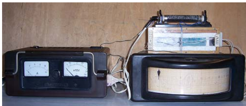
Рис. 3.17. Общий вид лабораторной установки для изучения явления Пельтье
