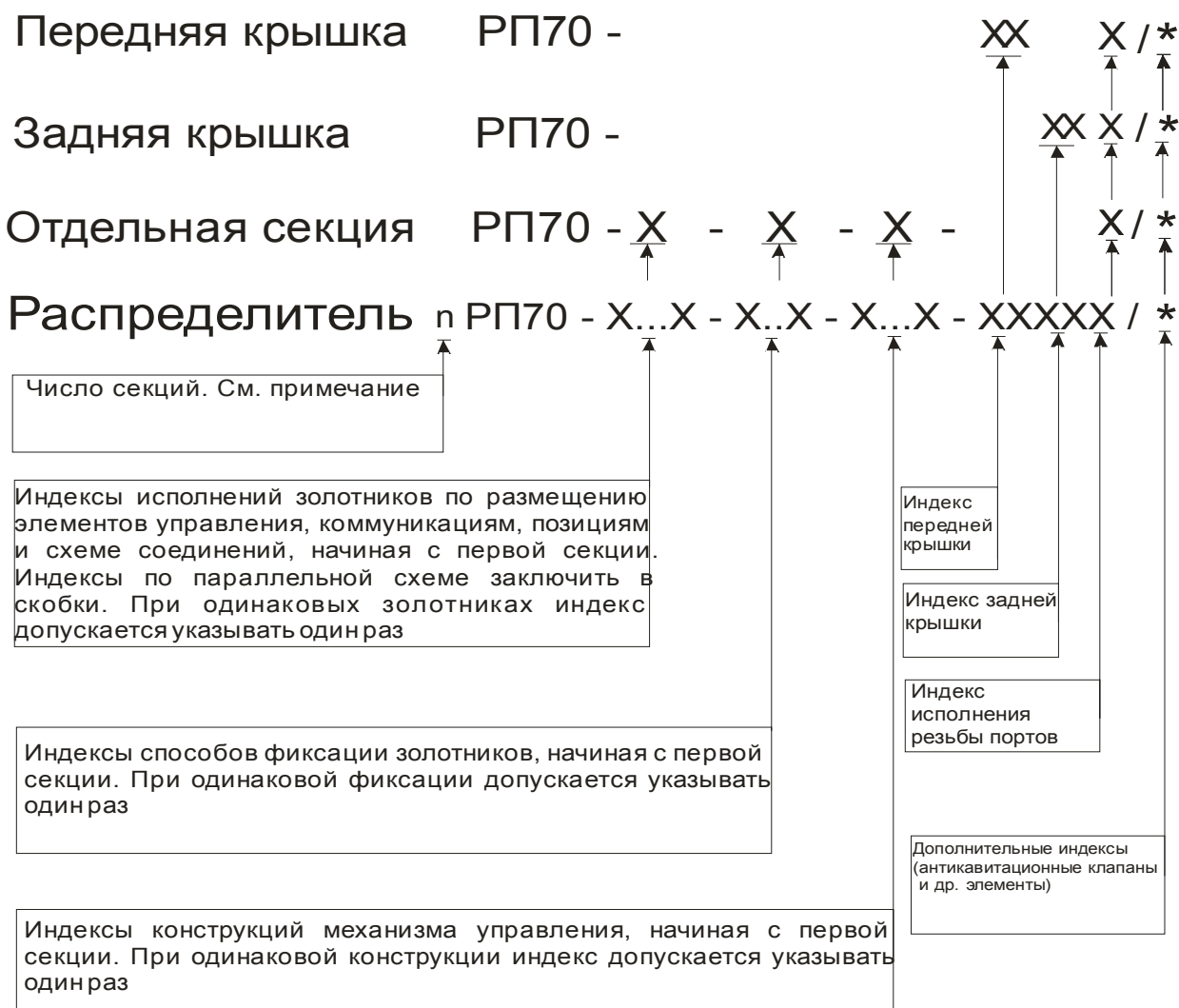
Рисунок 3.4 – Обозначение распределителей, отдельных секций и крышек
