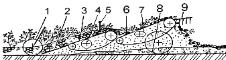
Рисунок 10 – Картофелекопатель КСТ-1,4А (схема технологическая): 1 – колесо копирующее; 2 – лемех; 3 – элеватор основной; 4 – встряхиватель активный; 5 – ворошитель пассивный; 6 – элеватор каскадный; 7 – встряхиватель пассивный; 8 – колесо ходовое; 9 – решетка сужающая
