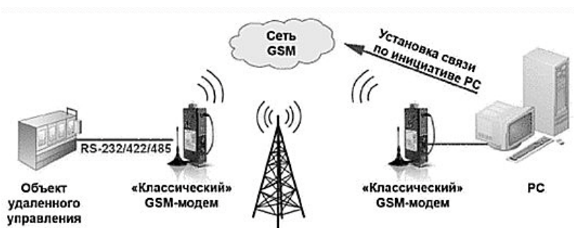
Рис. 2.24. «Классическая» топология системы удаленного управления оборудованием по сетям GSM
