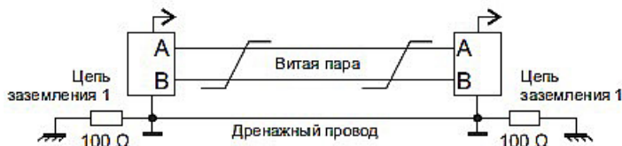
Рис. 2.8. Схема соединения по интерфейсу RS-485
