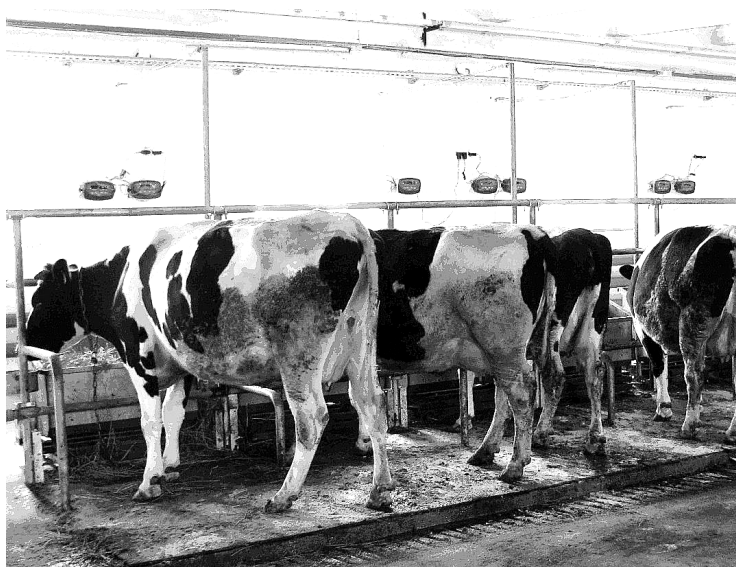
Рис. 2.3. Общий вид участка кормления коров с тензометрическими весами
