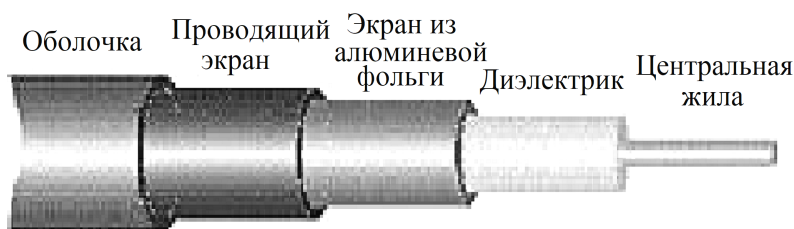
Рис. 1.41. Структура коаксиального кабеля
