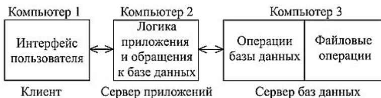
Рис. 2.27. Трехзвенная схема распределения частей приложения
