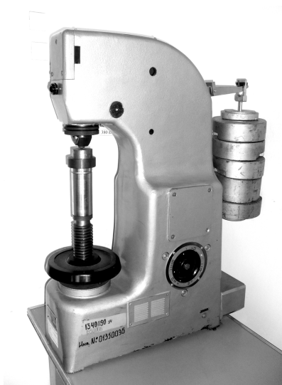
Рис. 1.2. Твердомер ТШ-2 для определения твердости по Бринеллю
