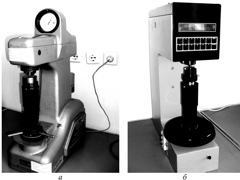
Рис. 1.4. Приборы для измерения твердости по Роквеллу: а – модель ТК-2; б – модель TP 5014-01M
