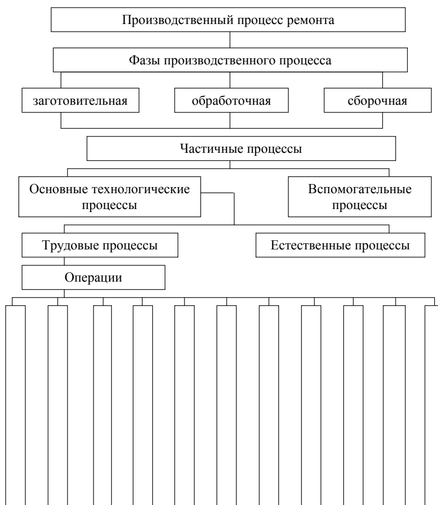
Рисунок 2.1 – Структура производственного процесса на ремонтном предприятии
