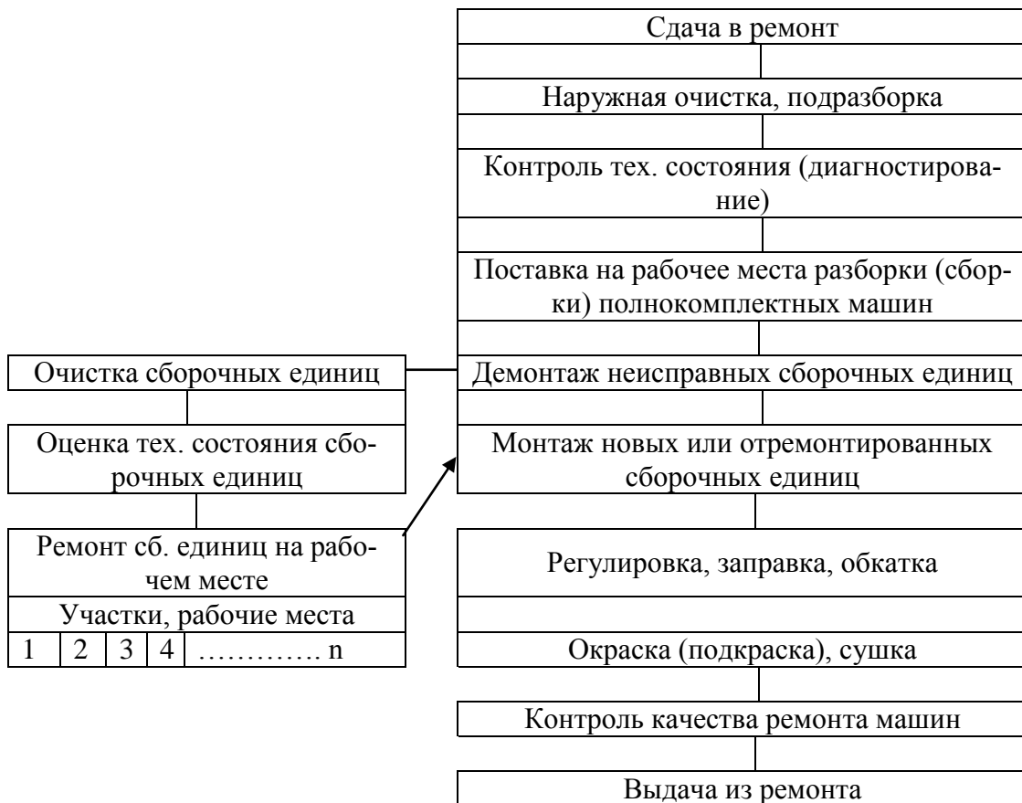
Рисунок 2.6 – Схема технологического процесса ремонта машин в ЦРМ
