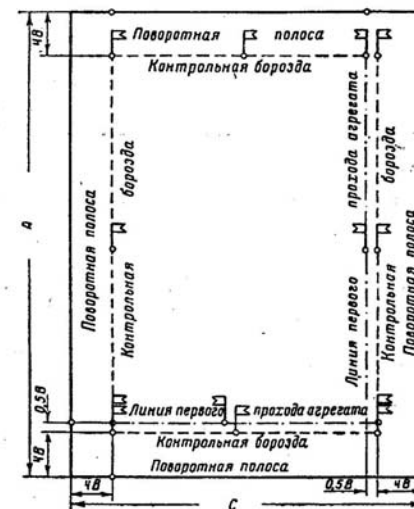
Рис. 1.10. Схема подготовки поля для продольно-поперечного посева
