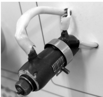
Рис. 56. Внешний вид нагревательного элемента и терморезистора
