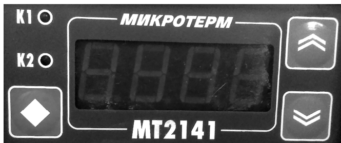
Рис. 75. Внешняя панель измерителя-регулятора температуры МТ2141
