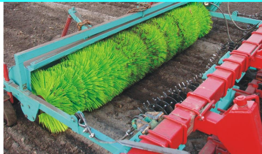
Механическое уничтожение ростков и всходов сорных растений в предпосевной, предпосадочный периоды
