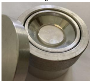
Рисунок 1. – Электротигель со специальными приспособлениями для определения наличия и количества воды в моторном масле: а – схема; б – внешний вид; 1 – электротигель; 2 – свеча накаливания; 3 – аккумулятор; 4 – цилиндрическая вставка; 5 – визуализирующее стекло; 6 – терморпара; 7 – система контроля и регулирования температуры
