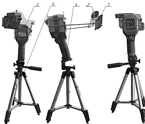
Рисунок 1. – Аппаратная реализация системы биометрической идентификации предмаститного состояния вымени дойного стада 1 – кронштейн крепления; 2 – видеокамера; 3 – тепловизор; 4 – регулятор угла наклона тепловизора; 5 – штатив
